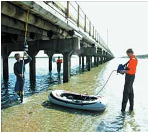
Figure 56 - Auscultation par méthode RADAR.
