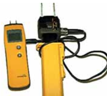
Fig. 55 - Humidimètre (méthode par résistivité).
