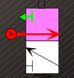
**Le signal émis est pneumatique donc incompatible avec l'entrée automate**
