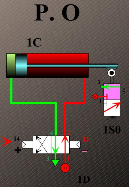
**Il est impossible de commander un préactionneur à commande pneumatique avec le signal électrique de l'automate**
