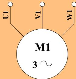
Lorsque le moteur est alimenté ainsi vu en bout d'arbre il tourne dans le sens horaire: M+
