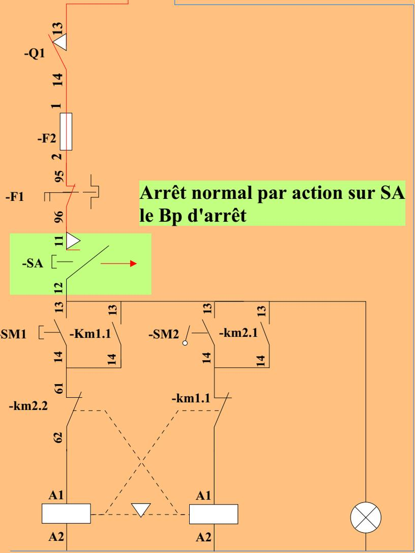
Arrêt normal par action sur SA le Bp d'arrêt
