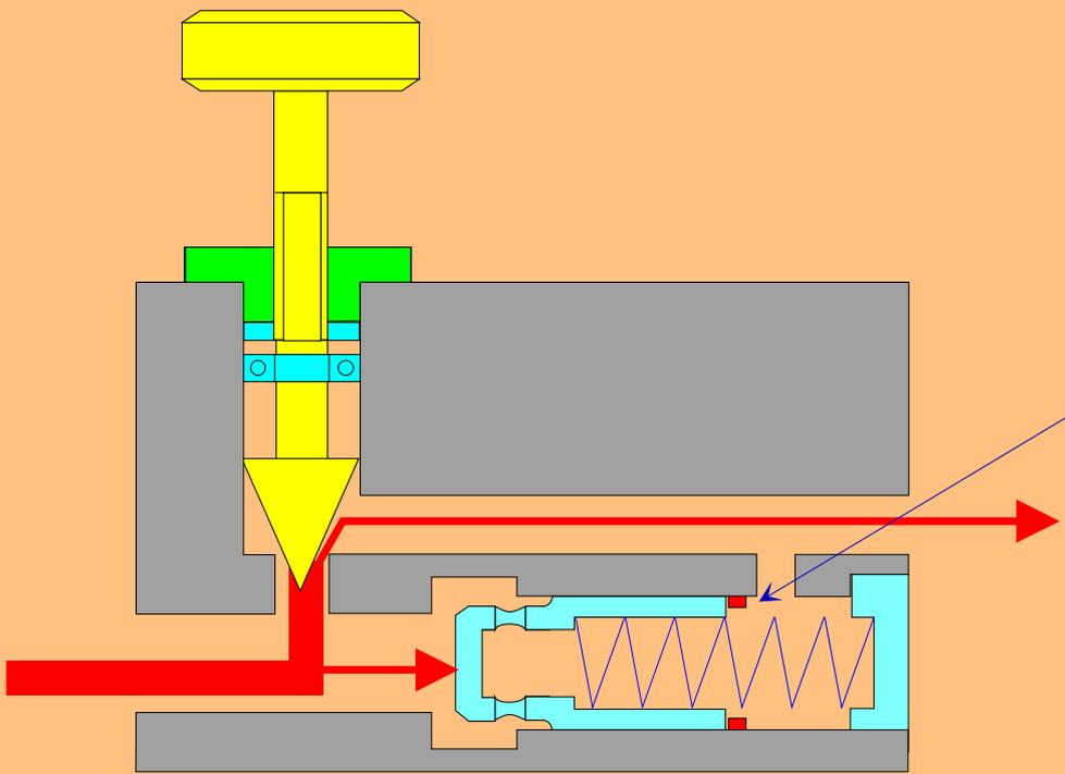
**Butée d'arrêt du clapet**
