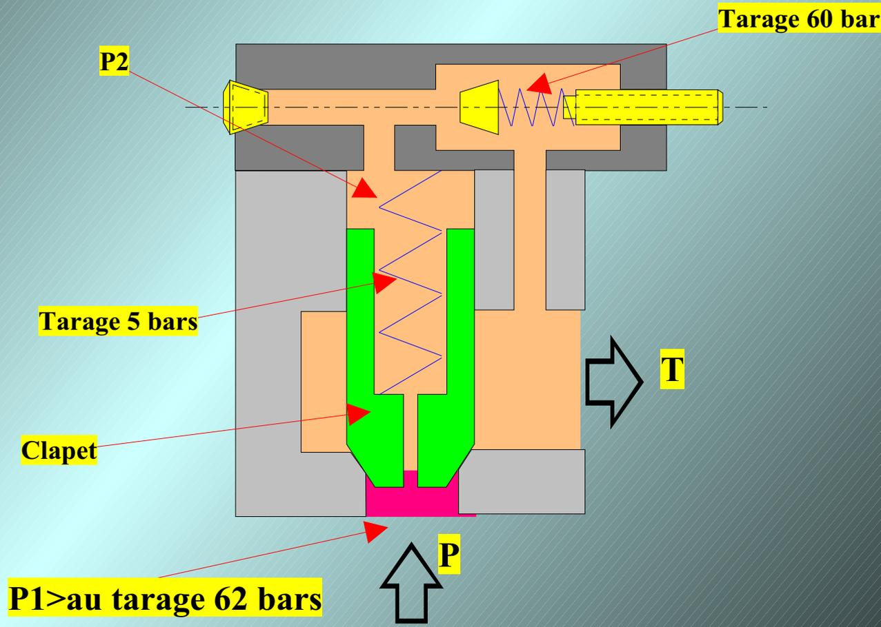
La chute de pression due au limiteur (ressorts) est de 2 bars.
