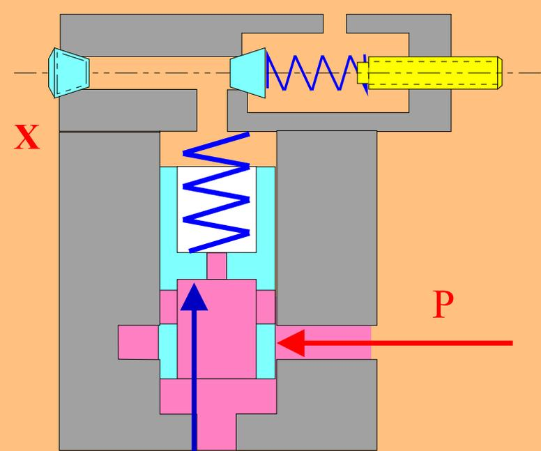
La pression fait monter le piston qui obstrue l'arrivée du fluide
