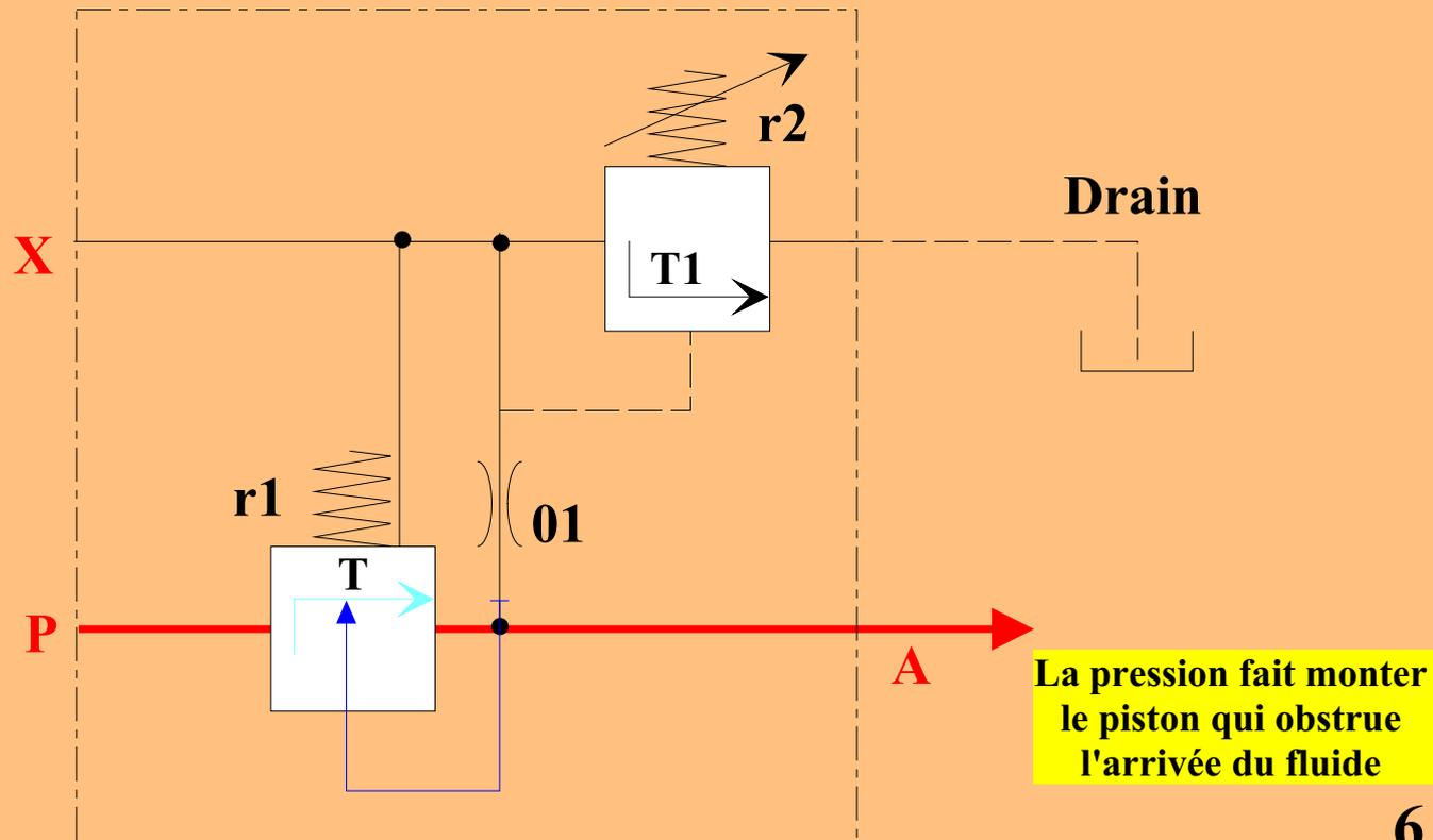
La pression fait monter le piston qui obstrue l'arrivée du fluide
