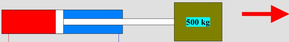
Pendant la sortie le clapet doit être ouvert
