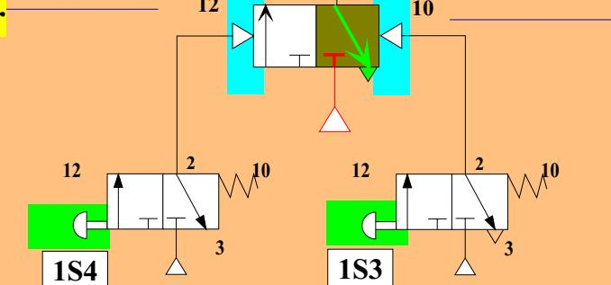
Double commande du préactionneur
